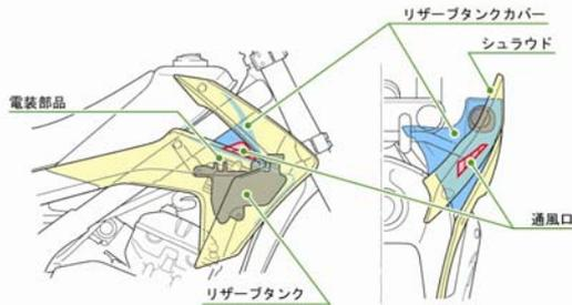
リザーブタンクカバー下に電装部品を配置、上面に通風口を設け、シュラウドからの走行風が効率良く電装部品を冷却。シュラウド内へコンパクトに集中配置し、従来電装品等があったシート回りをスリム化し、シュラウドから始まる流れるようなフォルムを実現しました。
