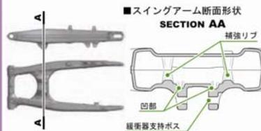
スイングアームの壁部内面に設けた凹部と、それに隣接する後(リアタイヤ側)の補強リブをリアサスペンションの支持ボスに沿って設けた剛性最適形状としました。
