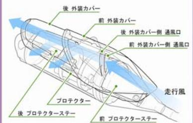
プロテクターステーとマフラー上面との間で空気通路を形成させ、プロテクターと前・後外装カバーにそれぞれ設けた通風口により、連なった走行風の通路を形成しました。
