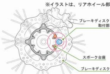
ハブの周方向で、ディスク取付部を挟む位置にスポーク台座を配置。スポーク台座に補強リブとしての機能を兼ねそなえ、台座以外の部分を薄肉化し重量を軽減しました。
