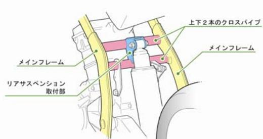
左右のメインフレームを連結する上下 2 本のクロスパイプを設け、リアサスペンションの取付部を上下 2 本のクロスパイプに跨って設置。
