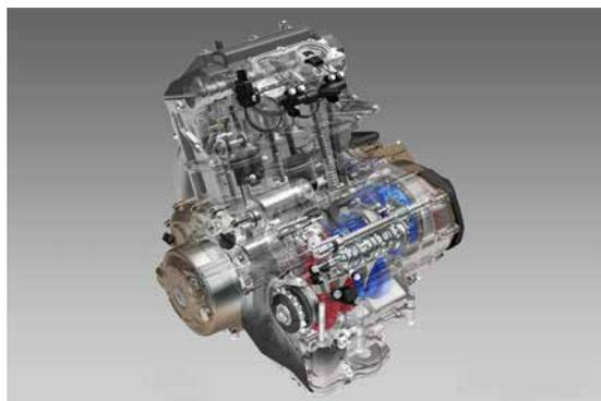
■DCT断面構造イメージ図
