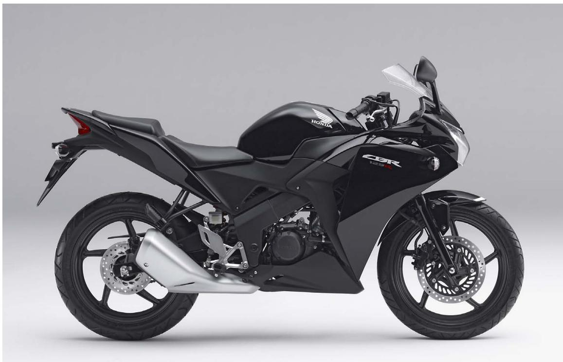
エントリー用のスポーツモデルの開発にあたり、力強く扱いやすい出力特性を目指し、PGM-FIの採用など燃焼効率に優れた124cm<sup>3</sup>の水冷4ストロークOHC 2バルブ単気筒エンジンを搭載しました。軽量コンパクトな設計としながら、高回転域までスムーズに回る特性としています。10,000rpm時に9.8kWの最高出力と8,000rpm時に10N・mの最大トルクを発揮するエンジンは、市街地の走行から郊外でのワインディングロードまで幅広い走りに対応しています。
