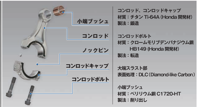
■チタンコンロッド部品構成図 (CGイメージ)
