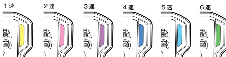
4. ライディングモード連動モード：ライディングモードの選択状態を色別に表示 (+エンジン高回転時は1-(WHITE)が作動)
