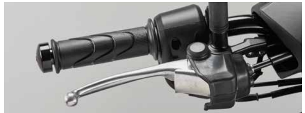
■リアブレーキロックノブ（BENLY e: I プロ/BENLY e: II プロのみ）
