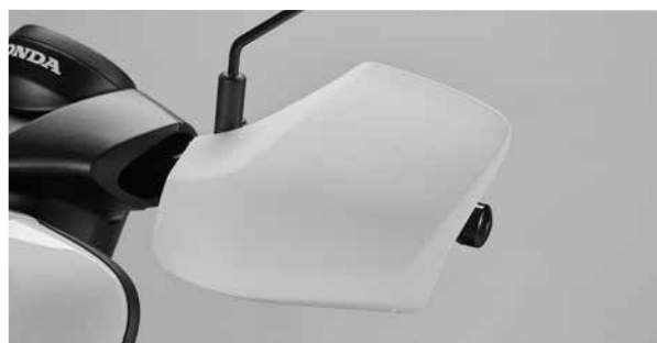
■ナックルガード(BENLY e: I プロ/BENLY e: II プロのみ)
