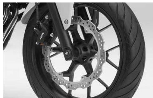
フロント：φ320mm 大径ディスク 2ポットキャリパー
