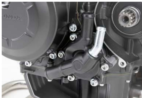
ウォーターポンプ回り
