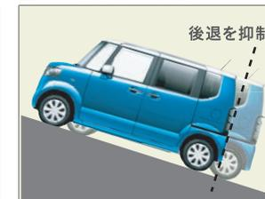
坂道発進時、ペダルを踏み換える瞬間のクルマの後退を抑制（約1秒間）。
