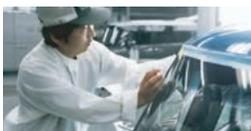
ボディは、塗装の高技能者が、丹精をこめてルーフを手塗り。N BOX+に合わせて作業架台などを設計した専用の塗装工房に完成車を入れ、細部まで丁寧にマスキングを施し、気温や湿度に応じて主剤・溶剤・硬化剤を調合した塗料で塗装。クリア塗装を重ね、機械乾燥と一昼夜の自然乾燥を経て、一台一台、送り出します。
