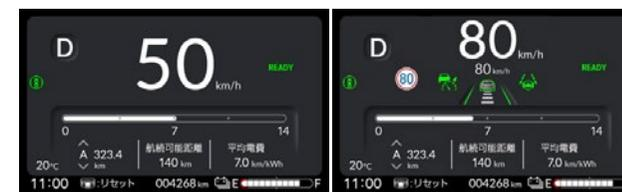
ステアリングスイッチの操作で、マルチインフォメーション・ディスプレイを画面下部に表示します。
