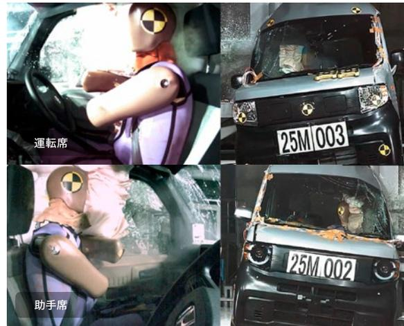
車体骨格で生存空間を確保し、サイドカーテンエアバッグシステム (前席/後席対応)/前席用i-サイドエアバッグシステムで乗員を保護
