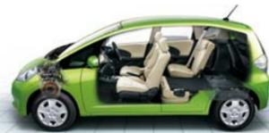
センタータンクレイアウトをはじめとした高効率なパッケージングによって、取り回しのしやすいコンパクトなボディでありながら広い空間と優れた使い勝手を備えたFITに、シンプルな構成で軽量・コンパクトなIMA（インテグレートッド・モーター・アシスト）を搭載。IPU（PCU+IMAバッテリー）を荷室床下にすっきりと収め、FITならではの居住性やシートアレンジ、積載性といった優れた特長をそのまま備えた、もっとも身近なハイブリッドカーを完成しました。
