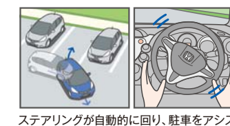
ステアリングが自動的に回り、駐車をアシスト
