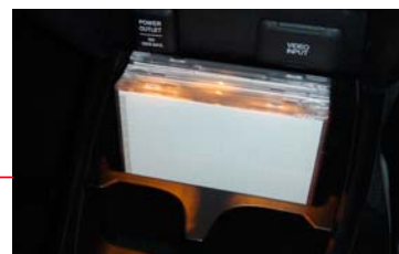
フロントコンソールボックスはスマートフォンに連動する照明を追加し、CDケースが4枚収納できる形状に変更
