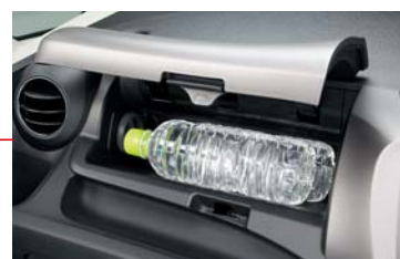
エアコン風による温度調整機能を備えたアッパーグローブボックスを採用(タイプ別設定)
