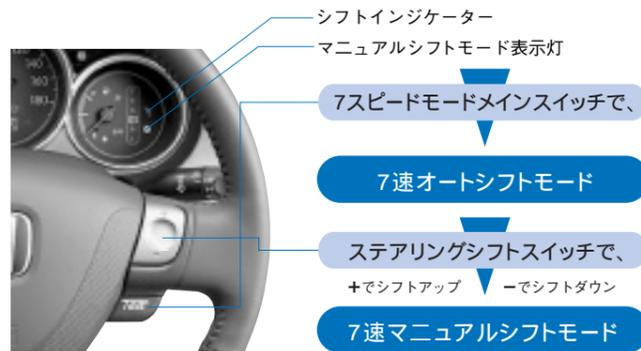
■「7速オートシフトモード」「7速マニュアルシフトモード」時に、7スピードモードメインスイッチを押すと、「自動無段変速モード」に戻ります。
