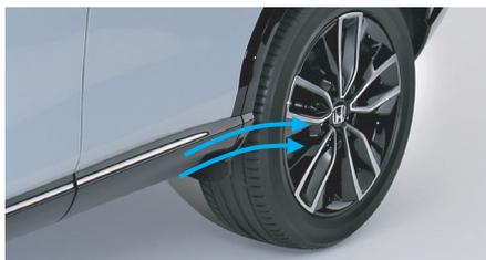
サイドシル後端をリップ形状とすることで、空気を整流し、後輪側面の乱れを抑制。
