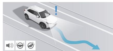
車線や草、砂利などの道路境界をはみ出しそうな際や対向車への接近時に車線をはみ出しそうな際、逸脱を防ぐようにステアリングを制御して回避操作を支援するとともに、マルチインフォメーション・ディスプレイとステアリング振動、および音で警告します。
