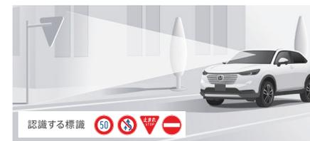
走行中に道路標識を認識してマルチインフォメーション・ディスプレイに表示します。速度を超過した場合はマルチインフォメーション・ディスプレイの表示を一定時間減速させ安全運転を支援します。
