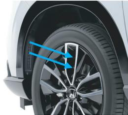
フロントバンパーから取り込んだ空気で前輪側面の乱れを抑制。
