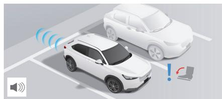
後方に障害物があるにも関わらずアクセルペダルを踏み込んだ際、パワーシステム出力を抑制して急発進を防止するとともに音とマルチインフォメーション・ディスプレイの表示で警告します。
