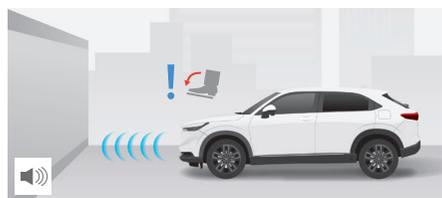
前方に障害物があるにも関わらずアクセルペダルを踏み込んだ際、パワーシステム出力を抑制して急発進を防止するとともに音とマルチインフォメーション・ディスプレイの表示で警告します。
