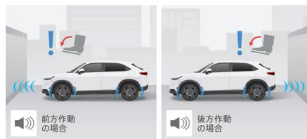
壁などの障害物の見落としにより衝突するおそれがある際、運転者のブレーキ操作を支援し、停止または減速することにより衝突回避・被害軽減を支援します。
