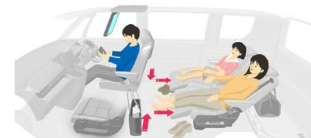
3列目シートが床下に格納されていれば、2列目ロングスライド後端位置でリクライニングが可能。のびのびとくつろげる明るく開放的な空間を体感できます。
