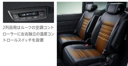
2列目用はルーフの空調コントロールローラーに左右独立の温度コントロールスイッチを設置
