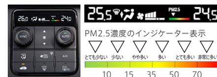
環境省が示す正常濃度35mgを超えると内気循環に切り替え、浄化を開始。日本の観測上限と言われる70mgから35mgに下げるまで約3分を想定
