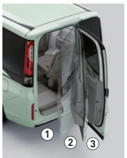
サブドアは、荷物を出し入れする際の安全性はもちろん、壁際での出し入れのしやすさ、高速道路のサービスエリアなどの安全性に配慮し、左開きに。また女性や子どもでもラクに開けることができるよう、アウタードアハンドルの位置を低めに設定。閉める際の荷重もテールゲートの約1/2の軽さにしています。
