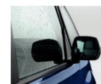
ドアミラーは雨滴を膜状に拡散する親水加工に加え、暖めて乾燥を促進。フロントドアの撥水ガラスとの相乗効果で、雨の日の視界を保ちます。
