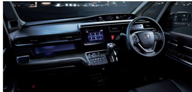
SPADA・Cool Spiritではソリッドな塊感を表現するために、インテリアパネルに採用した3Dフィルムの立体加飾は金属調としました。ゆらぎ模様の上に、さらに幾何学の柄がのった、新しい見え方が目をひきつけます。
