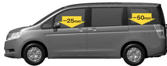
■ドアウインドウ／リアクォーターウインドウ下端位置説明図
