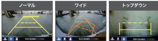
ハンドル操作に連動して、目安となる後退方向を表示するダイナミックガイドラインを採用。カメラ視界範囲を左右に広げ、後退時のより広い後方視界を提供します。
