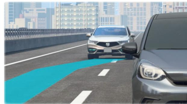
ハンズオフ機能付車線内運転支援機能で走行中、高度車線変更支援スイッチをONにすると一定の条件下でシステムが状況を判断して、車線変更や追い越しなどの操作を支援します。システムが車速の遅い先行車を検知した場合、ドライバーに告知を行ったうえで、追い越しや車線復帰を支援します。
