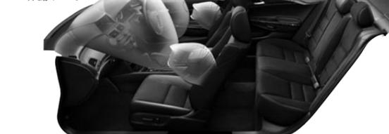
■写真は機能説明のため、運転席用&助手席用i-SRSエアバッグシステム、前席用i-サイドエアバッグシステム、サイドカーテンエアバッグシステムともに展開した状態を合成したものです。
