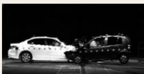
テスト車両によるクルマ相互の衝突実験 (左インスパイア)
