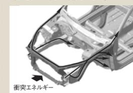
エンジンルームで衝突エネルギーを高効率に吸収することで、キャビンへの負荷を大幅に低減するとともに、相手車両への攻撃性を低減。
