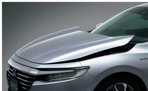
走行時に歩行者などとの衝突をフロントバンパーに内蔵したGセンサーが感知すると、アクチュエーターがボンネットの後ろ側を瞬時に約10cm持ち上げ、エンジンルームに空間を確保することで歩行者の頭部などへの衝撃を緩和します。
