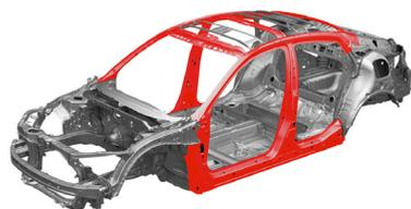
ボディー全体の骨格部材を組み立ててから外板パネルを溶接するインナーフレーム構造を採用。主要なフレームの結合効率を高め強固なボディー骨格を形成することで、補強材を最小限にでき軽量化を実現しました。
