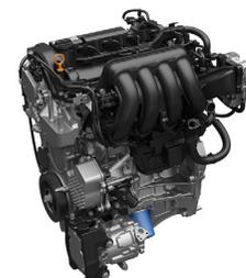
クラリティPHEVに搭載したエンジンを基本に、吸気・排気システムを専用設計して新型インサイトに搭載しました。優れた燃費性能を実現するため、アトキンソンサイクルとi-VTEC技術に加え、さらなる燃焼効率向上技術とメカニカルフリクション低減技術を投入。世界トップレベルの最大熱効率40.5%を発揮します。低燃費性能と高出力性能を最適バランスさせたi-MMD用エンジンです。
