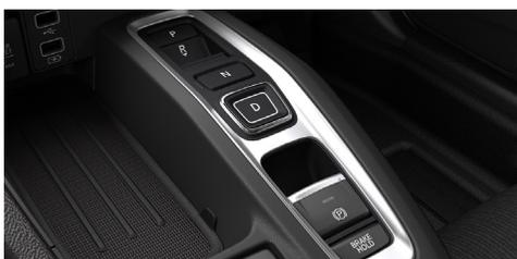
シフト操作が指一本で可能なスイッチ式のギアセクターを採用しました。スイッチは、ドライバーが手の届きやすい場所に集約配置したうえで、ドライブスイッチはプッシュ式、リバーススイッチはプル式とするなど、人間の感覚にマッチした設定としています。
