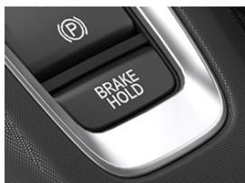
坂道や渋滞などでの停車時にブレーキペダルから足を離しても停車状態を保持。アクセルペダルを踏むと自動的に解除しスムーズに発進できます。
