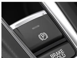
スイッチを軽く引き上げるだけでパーキングブレーキが作動し、ブレーキペダルを踏みながらスイッチを押すことで解除。また、渋滞時や信号待ちの際にブレーキを作動させた場合には、発進時にアクセルペダルを踏み込むことでブレーキを自動解除でき、ストップ&ゴーの続く走行シーンなどでドライバーの負担を軽減します。
