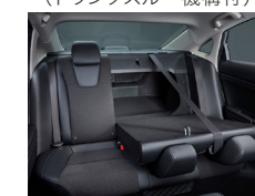
■6:4分割可倒式リアシート (トランクスルー機構付)
