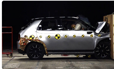
フルラップ55km/h前面衝突試験
