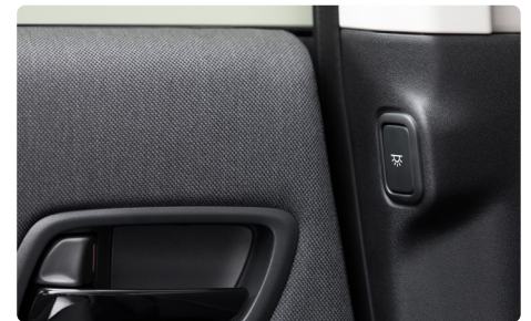
ダウンライトのスイッチは、壁スイッチをイメージし、手の届きやすいセンターピラーに配置。
