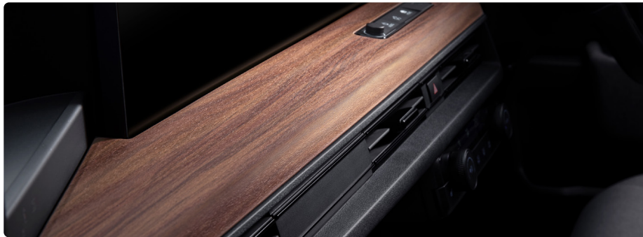
ディスプレイへの反射を抑えるよう濃いめのブラウンを設定。
