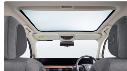
幅方向・前後方向とも、ルーフライニングの部分を極限まで減らし、優れた開放感を実現したスカイルーフ
