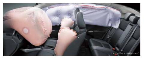
より迅速に展開し、保護性能をより長く持続させることで、乗員の体格や着座位置、衝突形態を問わず幅広く保護性能を発揮する運転席用i-SRSエアバッグシステム(連続容量変化タイプ)、及び助手席用SRSエアバッグシステムに加え、側面衝突時に保護性能を高める前席用i-サイドエアバッグシステム(容量変化タイプ)+サイドカーテンエアバッグシステムを装備しました。
