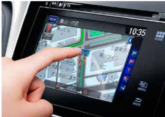
静電式タッチパネルを採用し、スマートフォン感覚の直感操作を実現。インターナビ・リンクプレミアムクラブのリンクアップフリー(専用通信機器+通信費無料\*2)に対応し、費用を気にせず多彩な情報サービスをフル活用できます。
