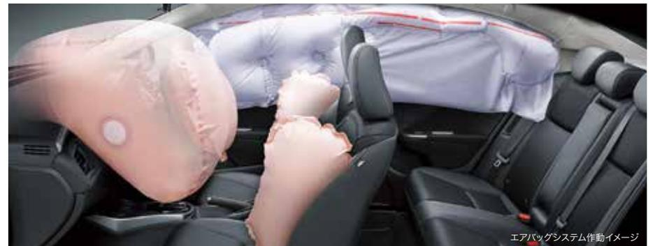
より迅速に展開し、保護性能をより長く持続させることで、乗員の体格や着座位置、衝突形態を問わず幅広く保護性能を発揮する運転席用i-SRSエアバッグシステム(連続容量変化タイプ)、及び助手席用SRSエアバッグシステムに加え、側面衝突時に保護性能を高める前席用i-サイドエアバッグシステム(容量変化タイプ)+サイドカーテンエアバッグシステムを装備しました。
