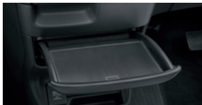
センターテーブル* 耐荷重3kgの引き出し式テーブル。使わないときはコンパクトに収納でき、ウォークスルーが可能です。
