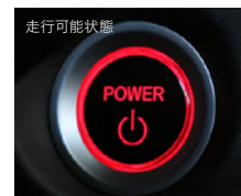
乗車時にドアオープンでスイッチ部の照明が点滅。走行中は赤く点灯します。
