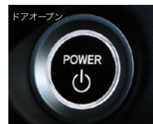
乗車時にドアオープンでスイッチ部の照明が点滅。走行中は赤く点灯します。
