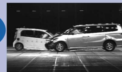
テスト車両によるクルマ相互の衝突実験(右エリシオン)
