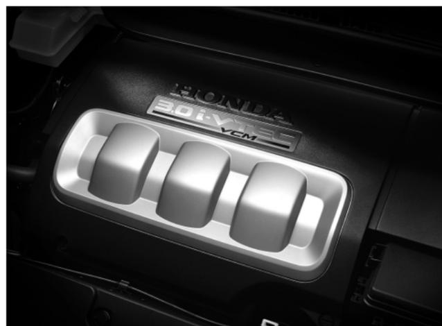
走行状況に応じて6気筒燃焼と3気筒燃焼を切り換える「可変シリンダーシステム」。
