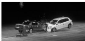
テスト車両によるクルマ相互の衝突実験
