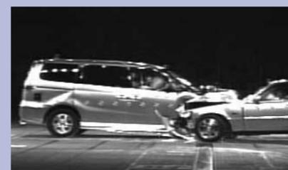
テスト車両によるクルマ相互の衝突実験(左エリシオン)
