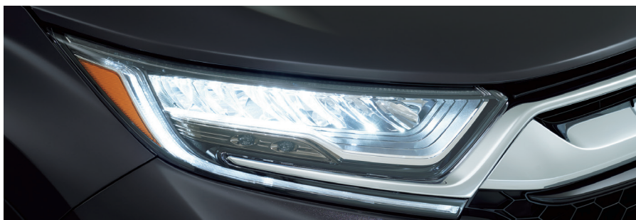
LEDヘッドライト+導光タイプLEDポジションランプ(アクセサリランプ機能付)
