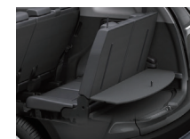
ボードを上セットした状態 荷物を上下に分けて積載可能。3列目シートを倒せば、 床面とフラットになります。 耐荷重: 100kg
