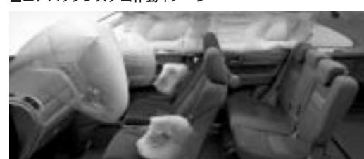
写真は機能説明のため、運転席用&助手席用SRSエアバッグシステム、前席用i-サイドエアバッグシステム、サイドカーテンエアバッグシステムとともに展開した状態を合成したものです。
