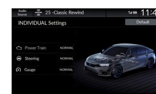
INDIVIDUALモード選択時、ドライブモードスイッチを前方に押すか、「カスタマイズ」を選択することでHonda CONNECTディスプレイに設定画面が表示されます。
