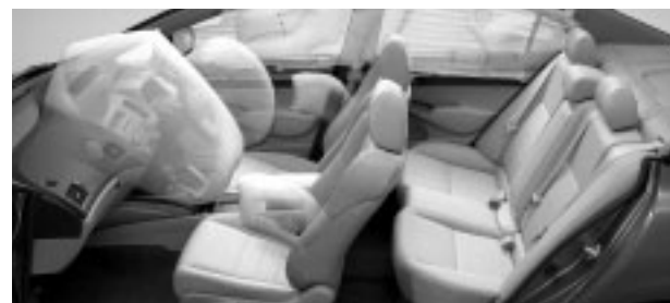
写真は機能説明のため、運転席用&助手席用i-SRSエアバッグシステム、前席用i-サイドエアバッグシステム、サイドカーテンエアバッグシステムともに展開した状態を合成したものです。
