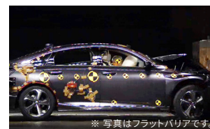
前面衝突 フラットバリア 55 km/h オフセットバリア 64 km/h
