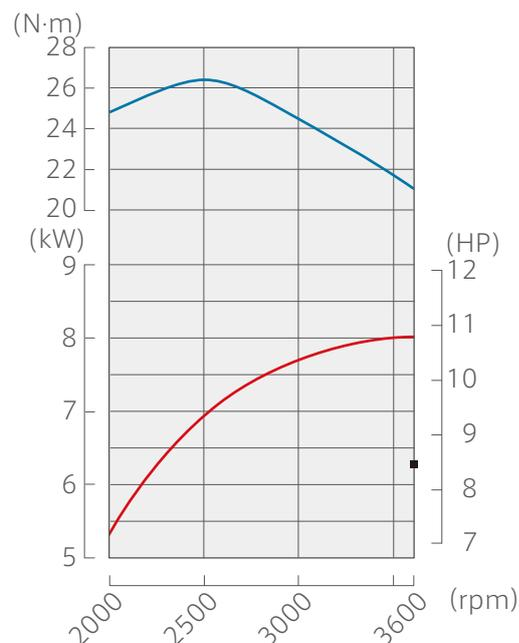
本紙に表示したエンジン出力はSAE J1349に準拠して測定された代表的なエンジンの出力値です。量産エンジンの出力は、この数値と変わることがあります。完成機に搭載された状態での実出力値はエンジン回転数、使用環境、メンテナンス状態やその他の条件により変化します。外観、寸法、乾燥重量はタイプによって異なります。また、本仕様は予告なく変更する場合があります。本紙の掲載内容は2020年4月現在のものになります。
