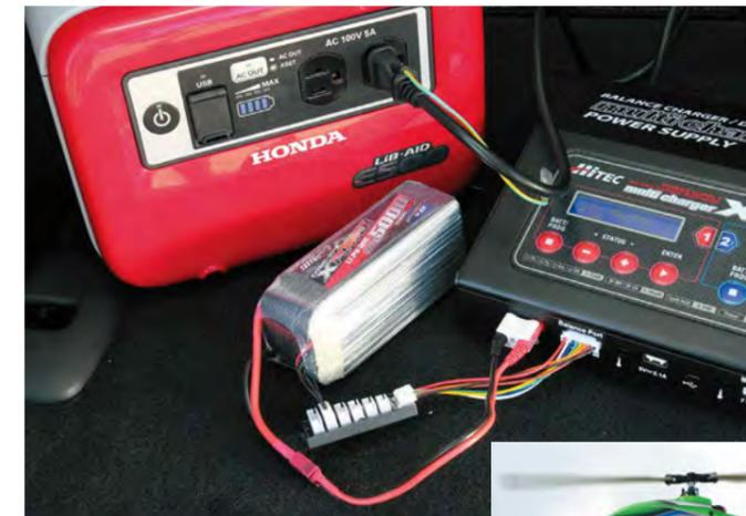
▶700~550クラスで使用される6セル5000mAhバッテリーに十分対応できる。450クラスの3セル2200mAhならたっぷり遊べる。
