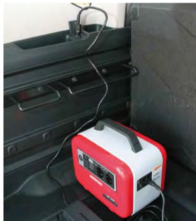
↑クルマのアクセサリソケット（DC12V）からも充電が可能。停車中に充電を行なう際はバッテリー上がりに注意する。なお車両側のバッテリー電圧が低い場合、充電器が低電圧異常を検知して充電を行なわないようになっている。
