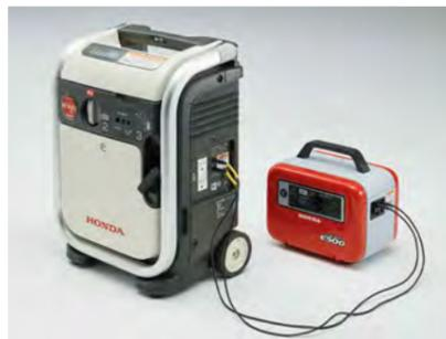
↑リベイドE500を2台繋いで最大1000W。またはHonda発電機（写真はEU9iGB エネポ／この場合500W+900W＝最大出力1400W）と並列接続（※）することで、より大きな消費電力の機器に対応。
