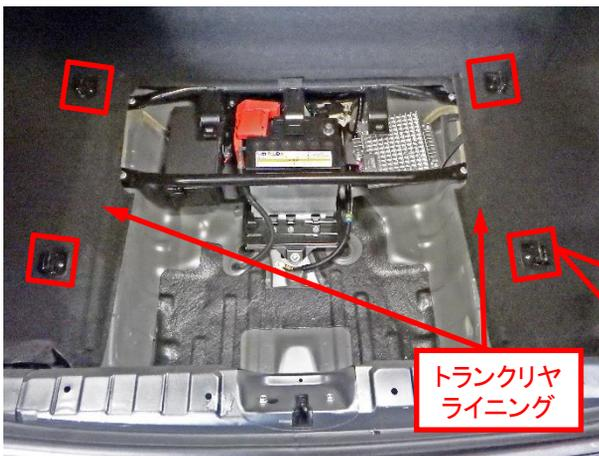
2. タイダウンフックのカバーを開けてボルト(4ヶ所)を外し、トランクリヤライニングを取り外す。
