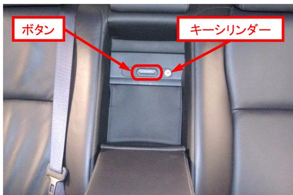
1. リアシートのアームレストを前に倒し、内蔵キーをキーシリンダーに差込み左に回して開錠してから、ボタンを押しカバーを開ける。
