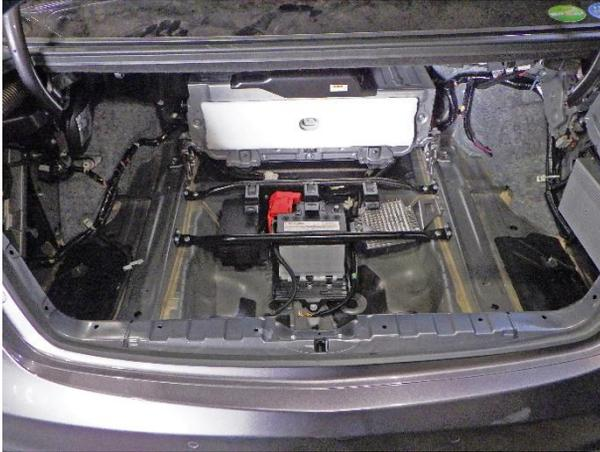
4. カプラとボルト(2ヶ所)を外し、IPUアウトレットダクトを取り外す。
