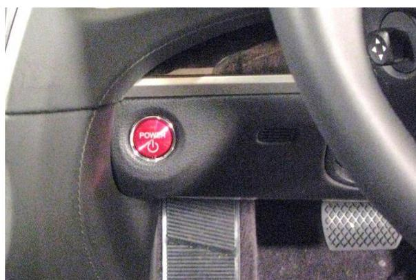
2. パーキングスイッチを押し、パーキングポジションにする。パワースイッチを約2秒以上長押しして、OFFにする。
