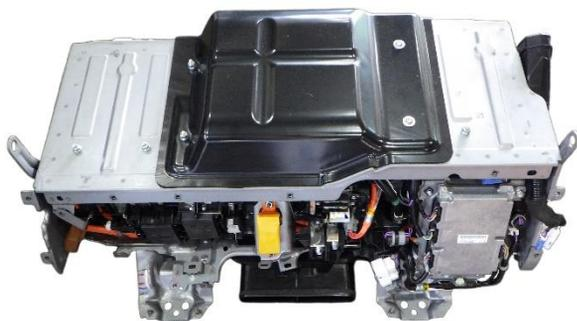
1. 車体から取り外したバッテリーにIPUフロントカバーを取り付ける。
