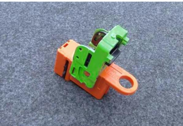
8. 取り外したサービスプラグは、確実にポケットなどに携帯し他の作業者が誤って接続しないようにすること。
