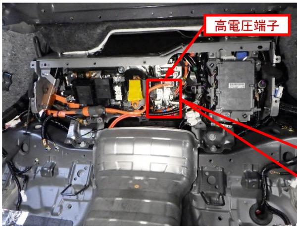
1. 高電圧端子間の電圧を、図の位置で測定し端子電圧が0Vであることを確認する。
