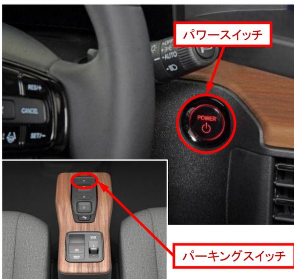
2. パーキングスイッチを押し、パーキングポジションにする。パワースイッチを約2秒以上長押しをして、OFFにする。
