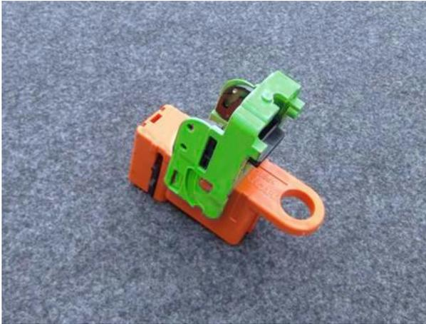
7. 取り外したサービスプラグは、確実にポケットなどに携帯し、他の作業者が誤って接続しないようにすること。
