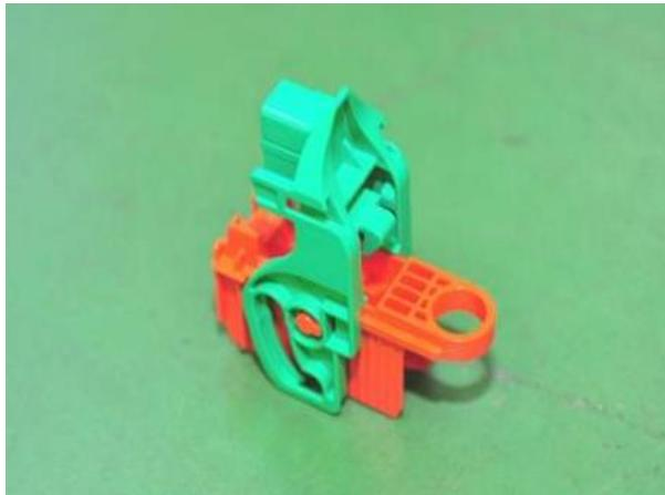
4. 取り外したサービスプラグは、確実にポケットなどに携帯し他の作業者が誤って接続しないようにすること。
