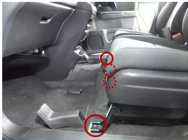
1. フロントシート左右のフロント側取り付け部のカバー(計4ヶ所)を取り外し、固定ボルト(4ヶ所)を取り外す。
