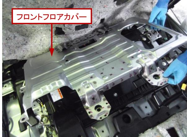
1. 固定ボルト(10ヶ所)を外してフロントフロアカバーを取り外す。
