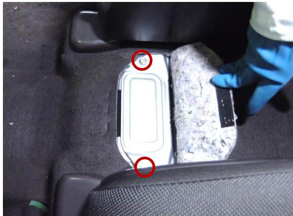
1. フロントシート中央のフロアカーペットをめくり、サービスプラグリッドのボルト(2ヶ所)を取り外す。
