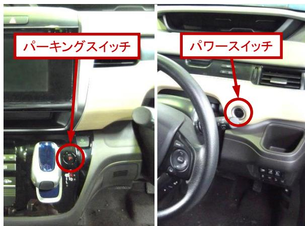
2. パーキングスイッチを押し、パーキングポジションにする。パワースイッチを約2秒以上長押しをして、OFFにする。
