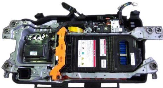
1. 車体から取り外したバッテリにPCUカバー及びIPUカバーを取り付ける。
