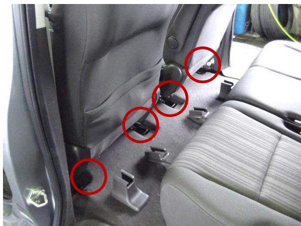
2. フロントシート左右のリア側取り付け部のカバー(計4ヶ所)を取り外し、固定ボルト(4ヶ所)を取り外す。
