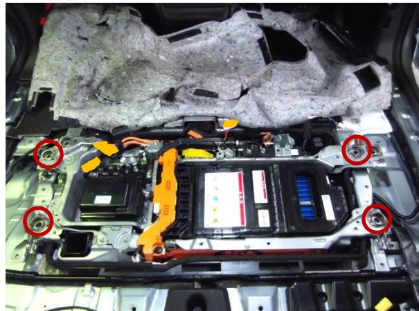
1. 車体とリチウムイオンバッテリ本体を固定しているボルト(4ヶ所)を取り外す。
